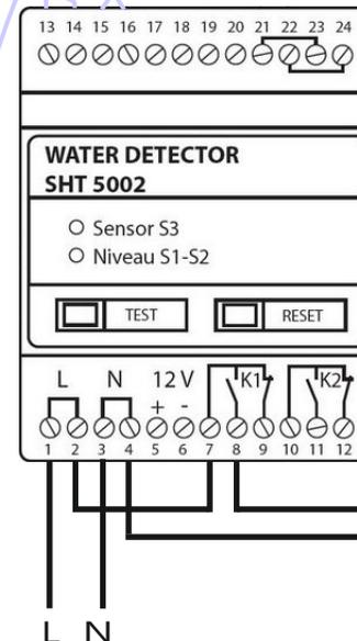
Erweiterte Nachspeisung für Teiche mit Fischbesatz im heißen Sommer: Sinkt der Schwimmer S1 auf sein unteres Niveau oder öffnet das Relais bei erhöhter Temperatur, wird die Pumpe aktiviert oder ein Ventil geöffnet, beim Erreichen des oberen Niveau an S2 stoppt die Pumpe oder das Ventil wird wieder geschlossen.
