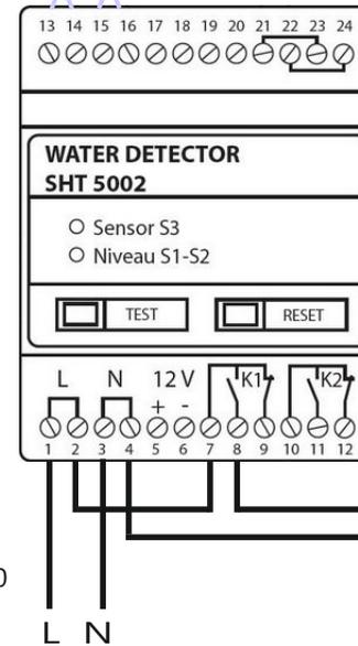
Einfache Wasser-Nachspeisung: Sinkt der Schwimmer S1 auf sein unteres Niveau, wird die Pumpe aktiviert oder ein Ventil geöffnet, beim Erreichen des oberen Niveau an S2 stoppt die Pumpe oder das Ventil wird wieder geschlossen.
